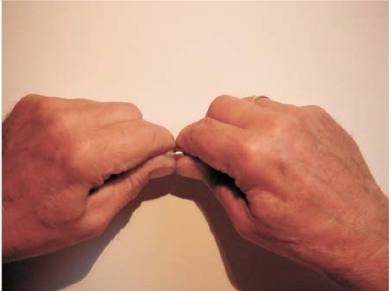
Bild. 2 För att korrekt ta bort ett skyddslock: Ta handtag och skyddslock mellan tumme och pekfinger i båda händerna så att fingrarna vidrör varandra. Öka trycket mellan tummarna och rör försiktigt på skyddslocket upp och ner tills det lossnar och kan tas bort från trådhållaren.
