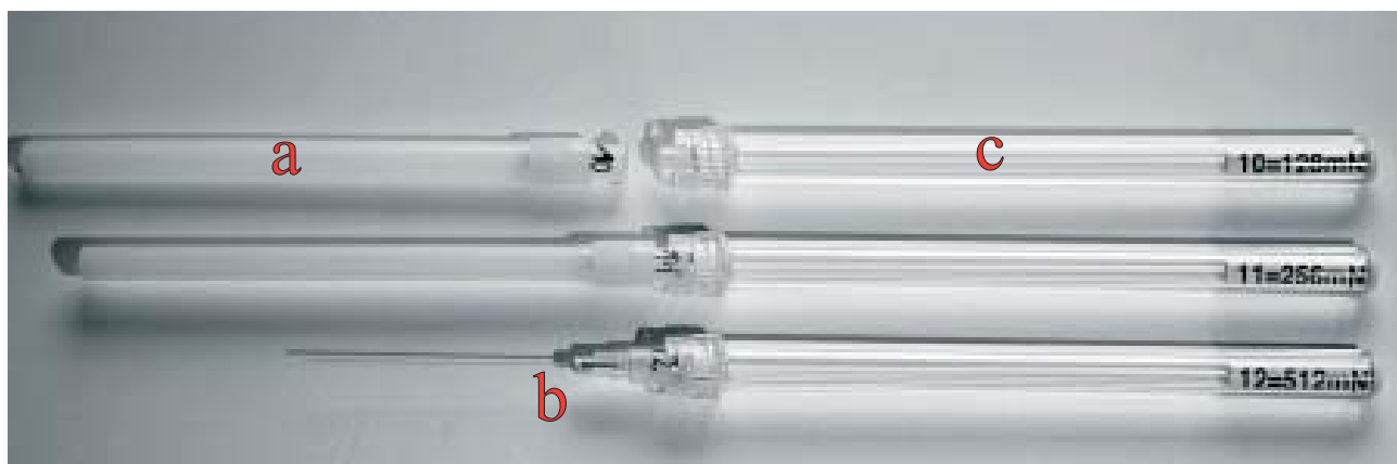
Bild. 1 Delar av ett OptiHair: skyddslock(a), trådhållare med tråd(b) och handtag(c)
